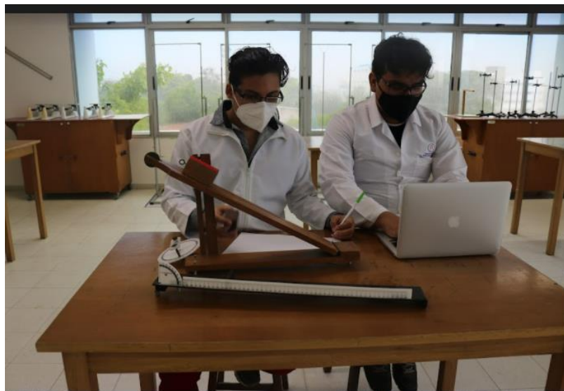
Ilustración 34. Sistema Mecatrónico para Caracterización de Materiales en Función de Medición de Coeficientes de Fricción Estática y Dinámica
